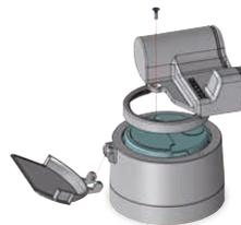
Fig. 4: Montaje del EDC-C
